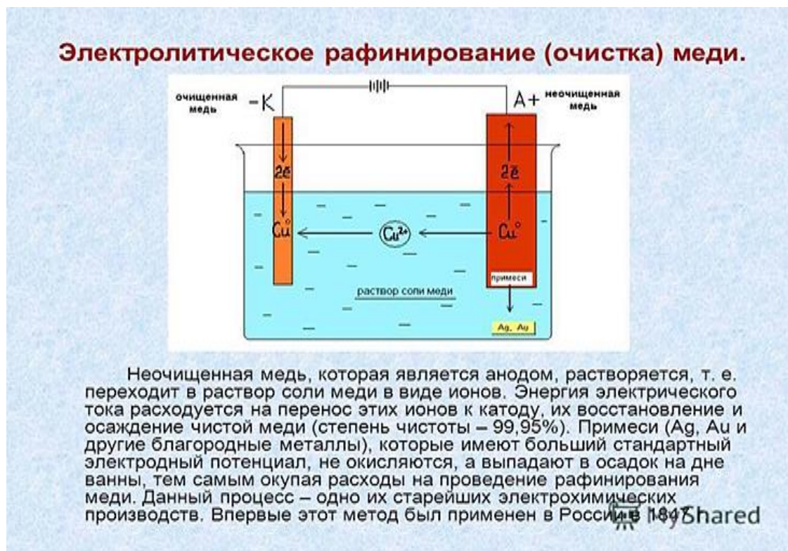
Рис. 4.15.3. Схема установки для электрорафинирования меди
