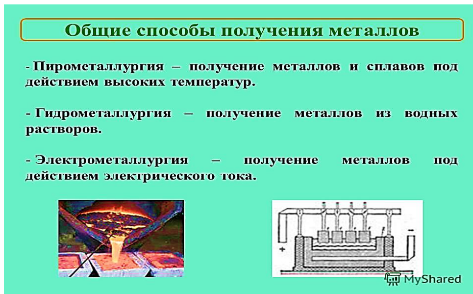
Рис. 4.15.1. Общие способы извлечения металлов из руд
